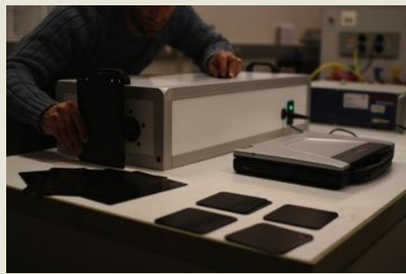
Bild 1: Das neue Messsystem zur zerstörungsfreien thermischen Schichtprüfung. Innovationen aus der IR-Sensorik und Optoelektronik ermöglichen künftig auch die Entwicklung von mobilen Handgeräten.
