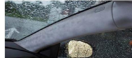
Verkleidungsbauteile für A-,B- und C-Säulen
