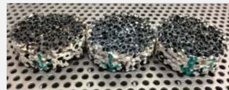
Keramikschaum mit Katalysatorbeschichtung
